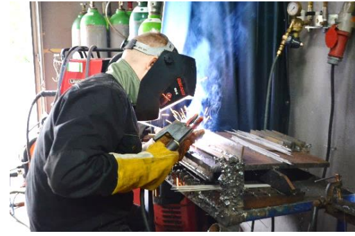
Spawanie blach i rur spoinami pachwinowymi metodą MMA 111 - elektrodą otuloną
